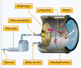
Figure 8-7. Airspeed indicator (ASI).
