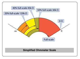
Figure 12-156. Ohm scale.
