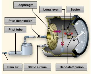
Figure 7-7. Airspeed indicator (ASI).
