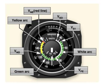
Figure 7-8. Airspeed indicator (ASI).
